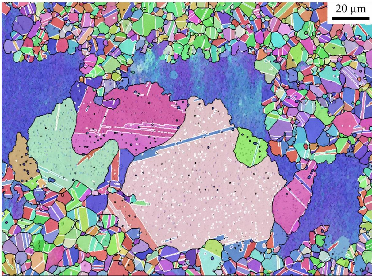
*Recristallisation statique d'un grain restauré hérité de l'étape de conversion du lingot en billette - Superalliage base nickel AD730™.*
